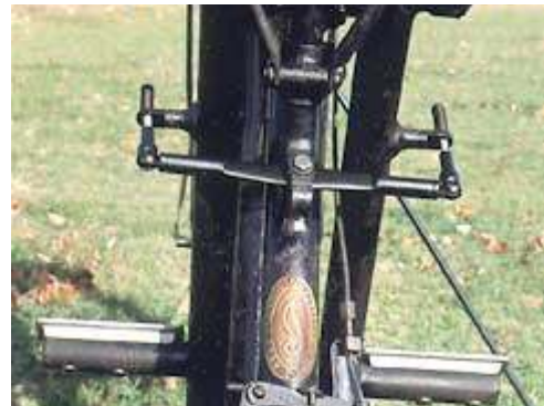
Die mattschwarz lackierte Wippe eingebaut.
