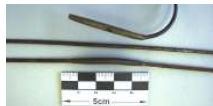
Die Drahtschlaufen aus der Feder sind mit Messinghülsen weich verlötet
