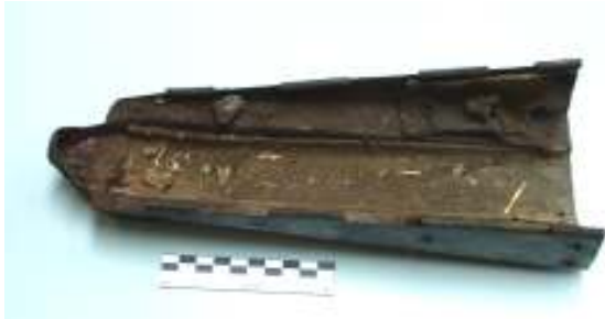
Die Innenseite des Gehäuses ist stark verschmutzt.
