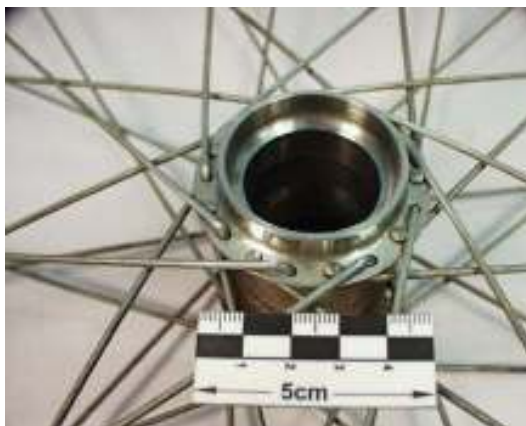
Die Nabe nach der Reinigung. Die Oberflächen sind durch immer erneuertes Öl sehr gut erhalten.
