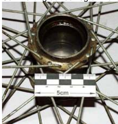
Hinterradnabe ohne Innenleben vor der Reinigung.
