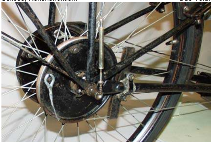
Zur Vorführung bereit: die eingebauten Antriebsseile.
