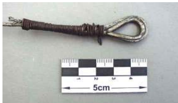
Eine Seilöse eines nachgebauten Seiles.
