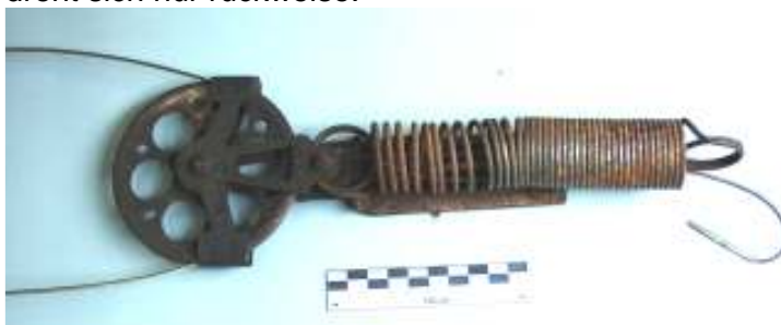
Die Umlenkrolle, ausgebaut, Vorzustand. Die Zugfeder ist überdehnt, die Oberflächen verölt bzw. rostig. Innerhalb der Feder befinden sich Drahtschlaufen, die offenbar den Federweg begrenzen sollten.
