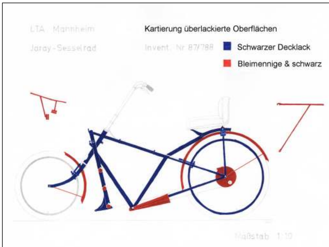
Das J-Rad ist schwarz überlackiert. Die blau gekennzeichneten Flächen bedeuten schwarzer Lack, die roten sind zudem mit Bleimennige grundiert. Die Oberfläche dieser Teile (vorwiegend Blechteile) ist besonders uneben (Pinselstriche).
