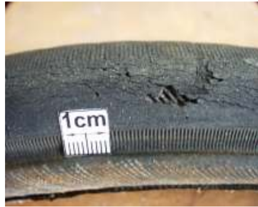
Stark beanspruchte Stelle, an der sich schon Gummiteile herausgelöst haben. Darunter ist das Cordgewebe zu erkennen.
