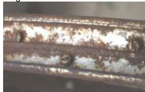
Die Innenseite der Felge im Vorzustand. In der Mitte ist die versteifende „Panzerrippe“ zu erkennen.
