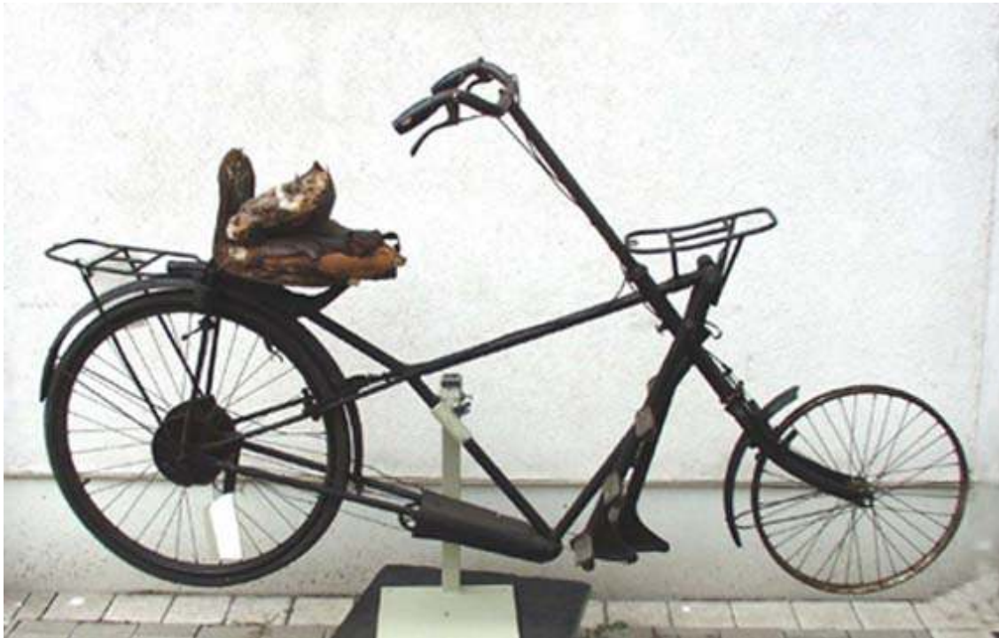
Das J-Rad im Vorzustand. Der vordere Reifen ist bereits demontiert, das Rad auf dem Montageständer montiert.
