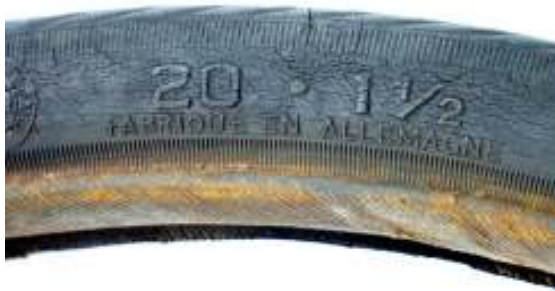
Vorderreifen im Vorzustand. Die Oberfläche ist rissig und spröde. Im Wulstbereich haftet Rost von der Felge .
