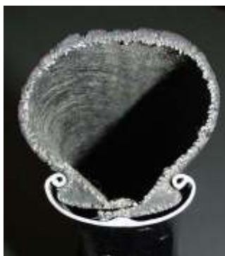
Bild 31 : Wulstfelge mit Reifen im Querschnitt.
