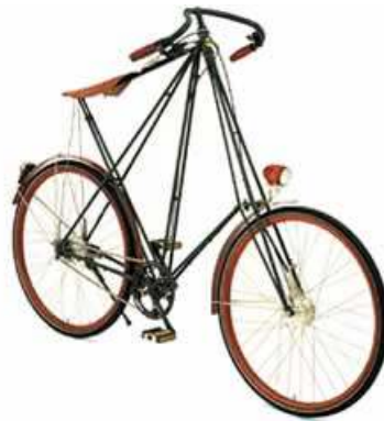
Das Pedersen-Rad wurde 1897 in Dänemark entwickelt. Es besitzt einen bequemen, frei gespannten Sattel. 5
