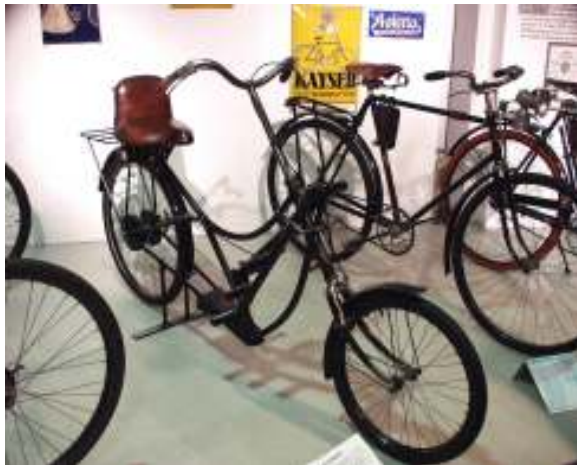
Bild 9 Ein J-Rad aus dem Bestand des Deutschen Museums München. Rahmen und Blechteile sind neu lackiert, die blanken Teile neu vernickelt.
