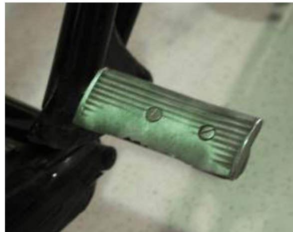
Bild 10 Ein Pedal des Rades. Die starke Abnutzung steht im Widerspruch zum neuwertigen Gesamtbild des Rades.
